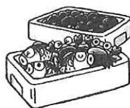
浮力を利用し養殖イカダや浮桟橋に用いるフロート
