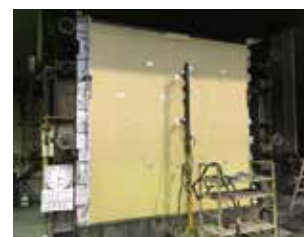
防火試験後 （せっこうボード：加熱裏面） 外観異常なし
