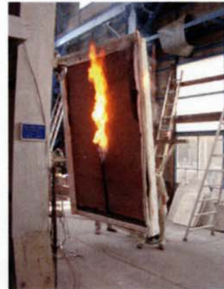
防火認定試験風景 (試験後も外装材の脱落なし)
