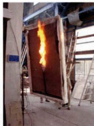
防火認定試験風景 (試験後も外装材の脱落なし)
