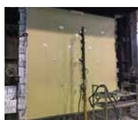
防火試験前 （せっこうボード：加熱裏面）
