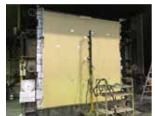
防火試験後 （せっこうボード：加熱裏面） 外観異常なし
