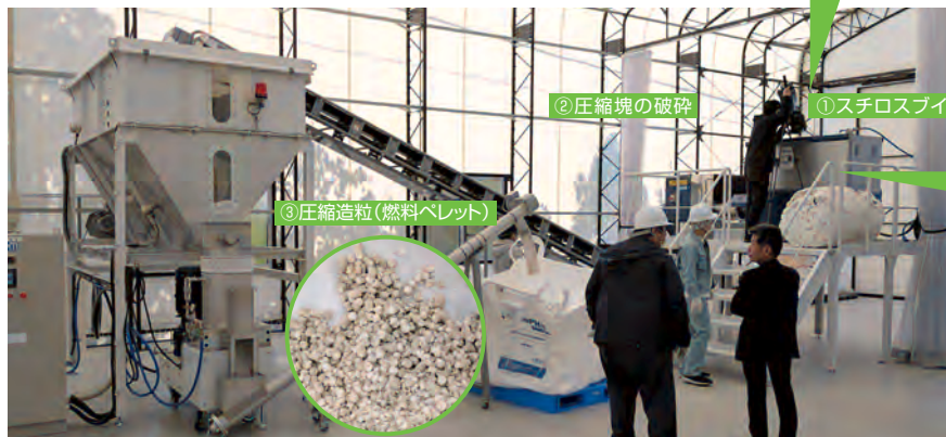
広島県漁連・処理フローと計画量・フロート:①破碎圧縮(スチロスビ)→②圧縮塊の破碎、ベルトコンベア搬送→③圧縮造粒(燃料ペレット):84トン(24千個)/年 ・カキパイプ:破碎処理(ボイラー燃料)6トン/年
