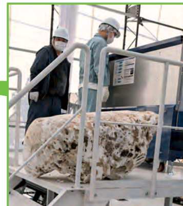
広島県漁連・処理フローと計画量・フロート:①破碎圧縮(スチロスビ)→②圧縮塊の破碎、ベルトコンベア搬送→③圧縮造粒(燃料ペレット):84トン(24千個)/年 ・カキパイプ:破碎処理(ボイラー燃料)6トン/年
